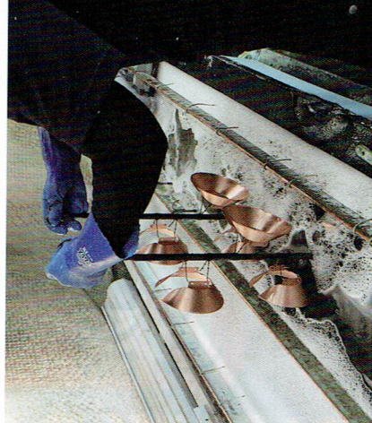
鉄鋼・銅・銅合金のメッキ処理には、脱脂、メッキ乾燥まで6つの工程がある
